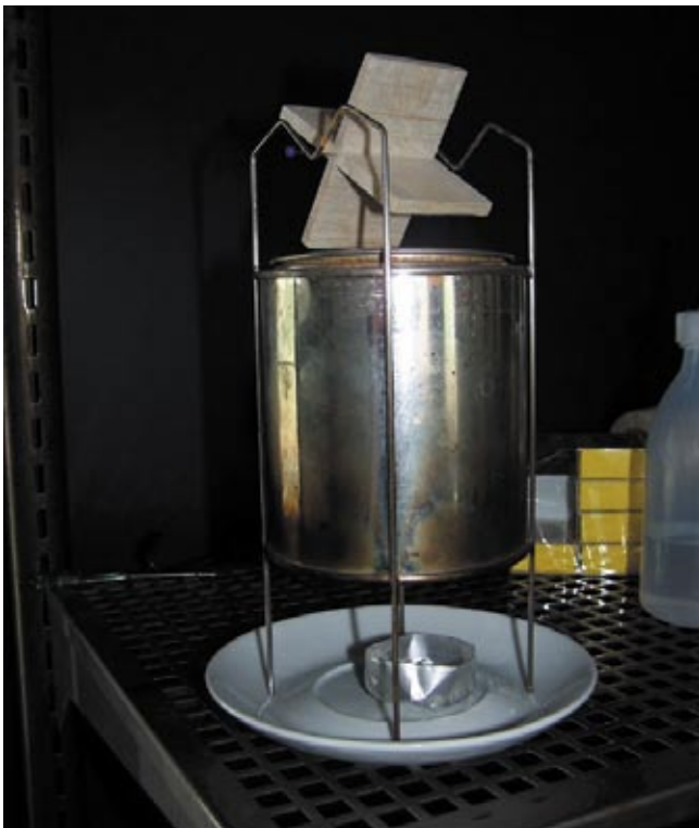
Damp turbine med hjemmelavet skovlhjul.
