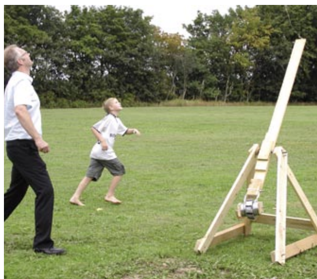
En blide består af stel, hovedarm, ballast og slyngpose
