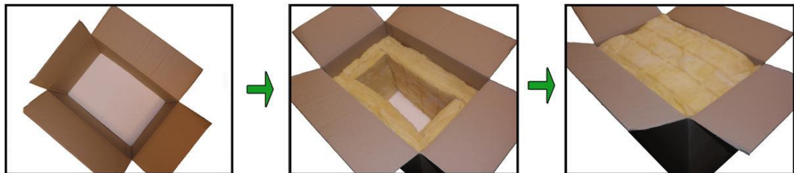
Figur 16: Fremgangsmåde for isolering af paphus
