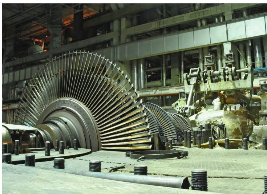
Her ses en turbine fra et kraftværk. Normalt er sådan en lukket inde, men denne skal repareres, så derfor kan man se den. Størstedelen af elektriciteten i verden produceres ved hjælp af turbiner.
